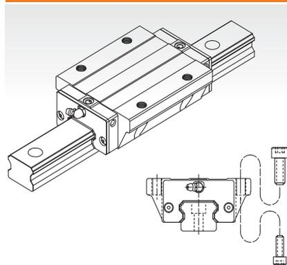
與SME-EB型具有相同斷面尺寸，增加滑塊的長度，並增加負荷滾珠數，提昇整體的負荷能力。
